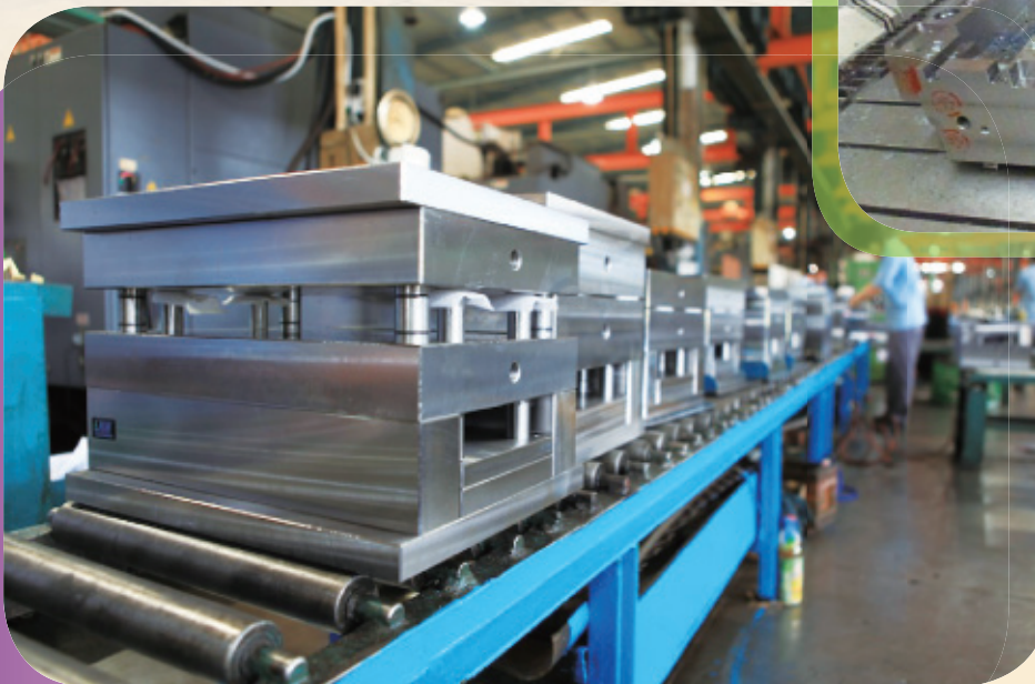
▼ 亞洲標準模架的組裝生產線。 Assembly line for Asian standard mould base.
