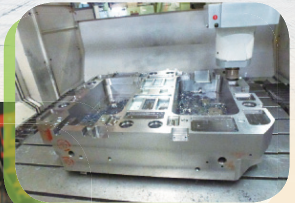
▲ 高速加工中心專門切削形框及精孔。 High speed CNC machining centre for pocketing and making precision holes.
