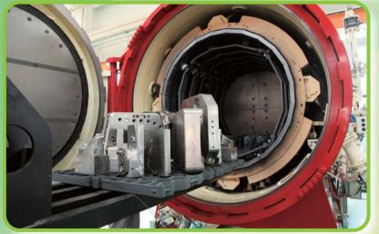
■ 位於中國杭州廠的熱處理車間,擁有不同容量的先進真空熱處理爐, 為生產壓鑄模具及工程塑料所用硬模之客戶提供高效服務。
