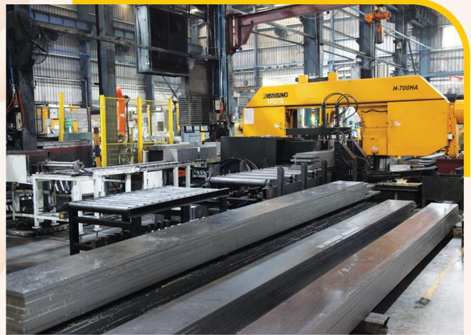
鋼材板件於加工前在切割區被切割成粗形
