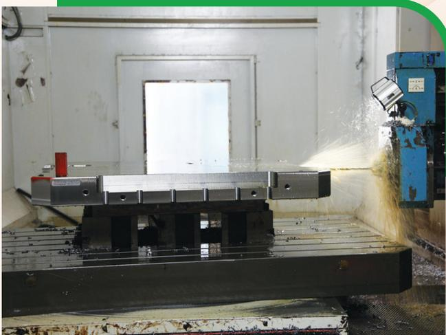
加工中心正為一件大型模架進行加工
