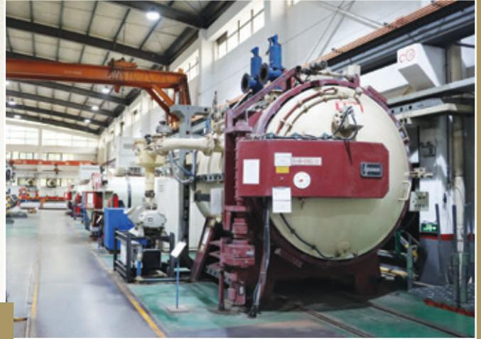
真空熱處理爐提供穩定的熱處理加工服務
