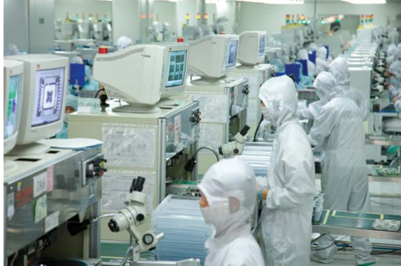
晶片直接封裝 (COB) 作業
