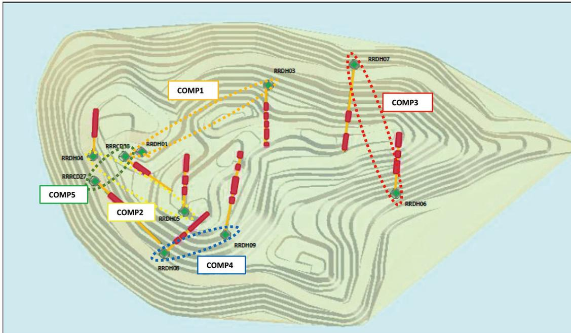
圖2 Rustlers Roost礦坑平面圖展示選礦試驗鑽孔位置。
